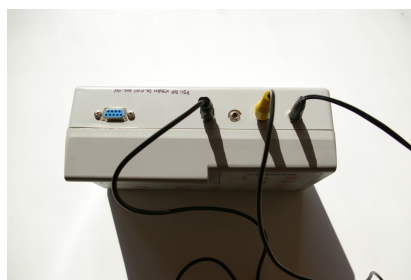
Rysunek 2.4: Spadkownica: podłączenie elektromagnesu i bramki do panelu kontrolnego
