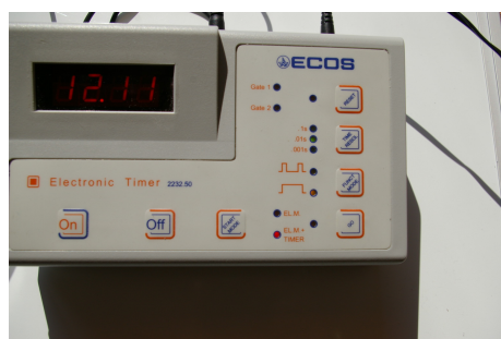
Rysunek 2.5: Pannel kontrolny spadkownicy
